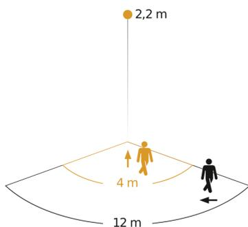
Possibile altezza di montaggio: 1,80 m – 2,50 m
